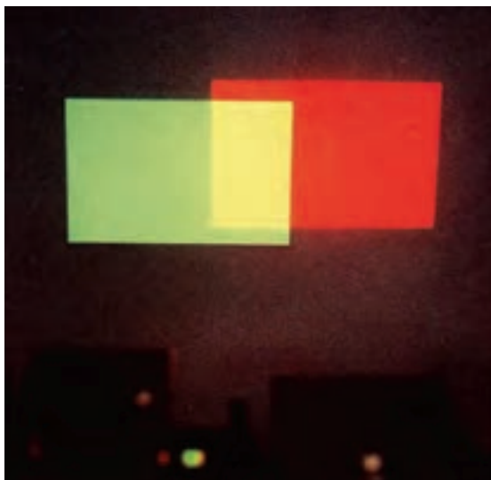
شکل ۸-۷- از ترکیب افزایشی سبز با قرمز که مجموعه‌ی طول موج‌ها متوسط و بلند است، رنگ زرد حاصل می‌شود. قرمز + سبز = زرد
