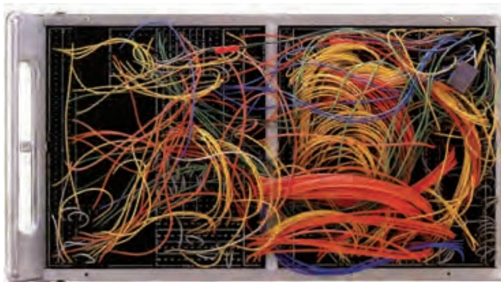
شکل ۶-۶ - پشت یک صفحه کنترل و مدارهای یک دستگاه الکترونیکی، (۵۲/۷ × ۲۹/۲ سانتی‌متر)، ۱۹۵۰- کاربرد رنگ در روکش سیم‌هایی که امروزه در صنایع الکتریکی و الکترونیکی استفاده می‌شوند، یکی از وجوه کاربردهای صنعتی رنگ می‌باشد.
